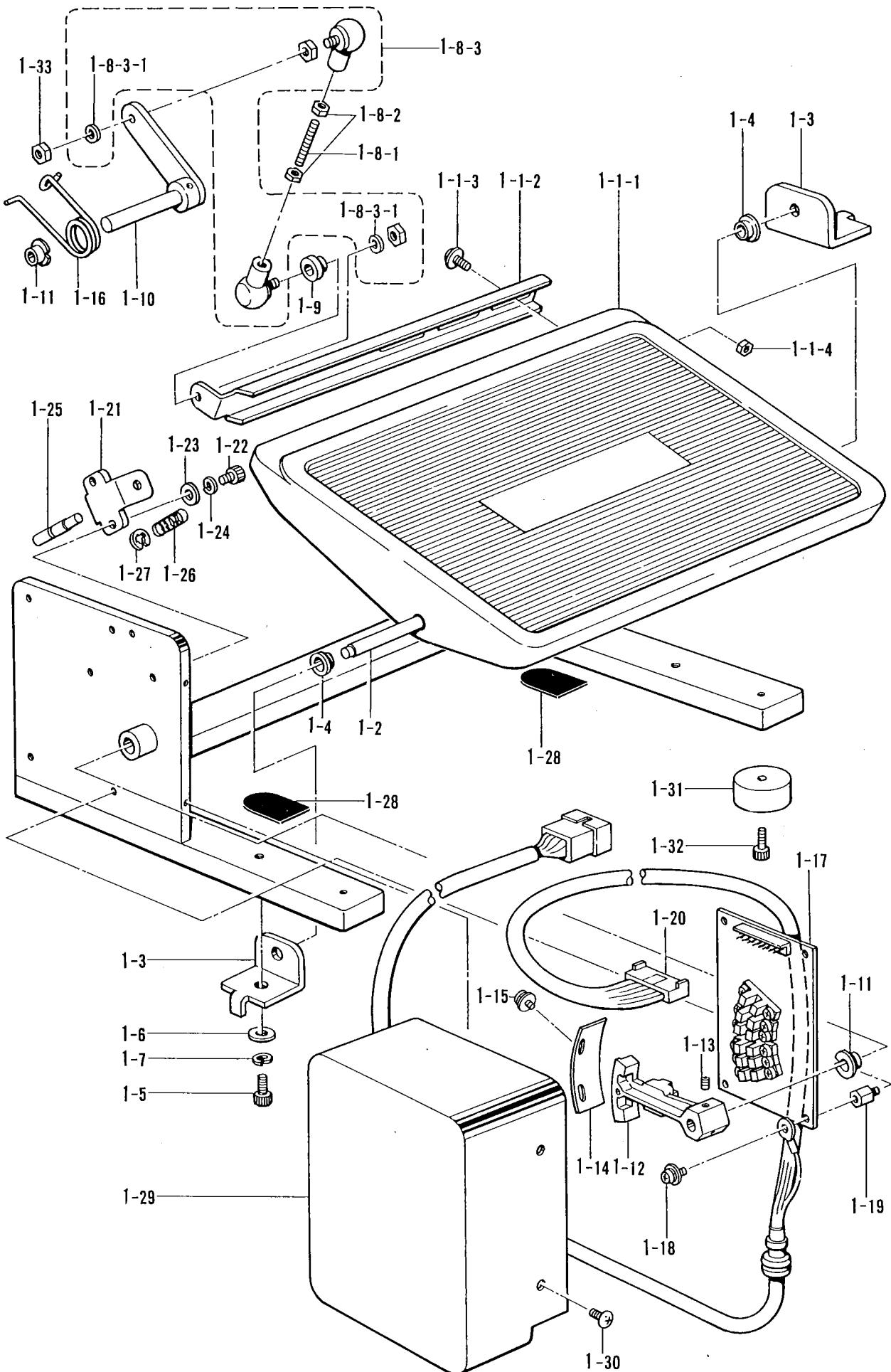
**U. 踏板関係 / Foot switch pedal mechanism / Fußbetätigung /
