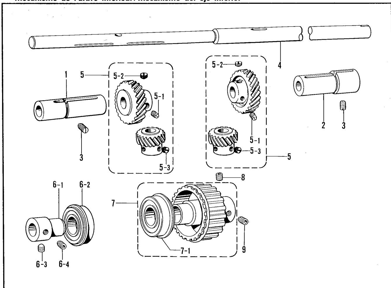
C. 針棒搖動関係 / Needle bar rocking mechanism / Nadelstangenbetätigung /
