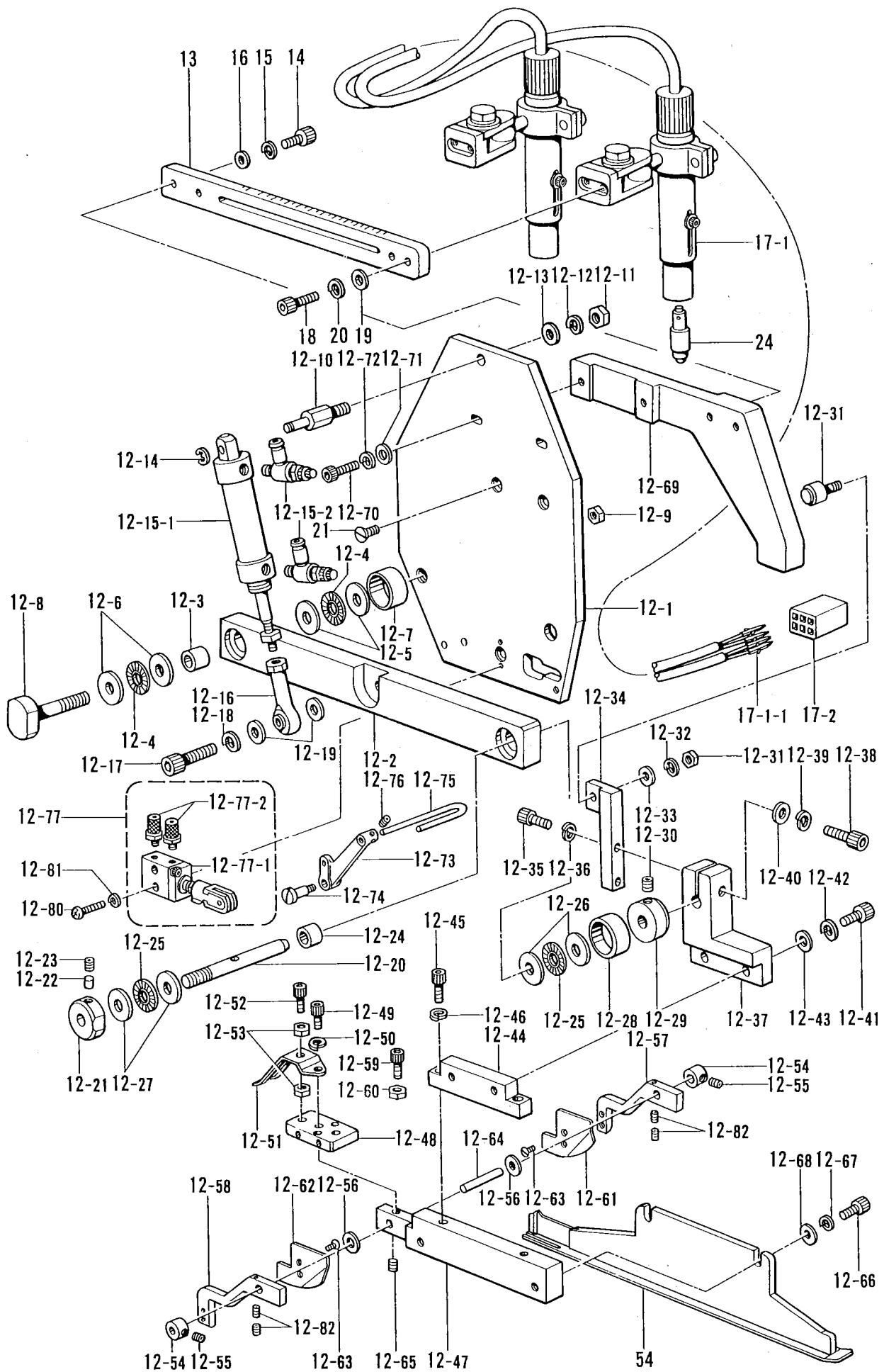
R. 布制御関係/Cloth control system mechanism/Stoffführungs vorrichtung /
