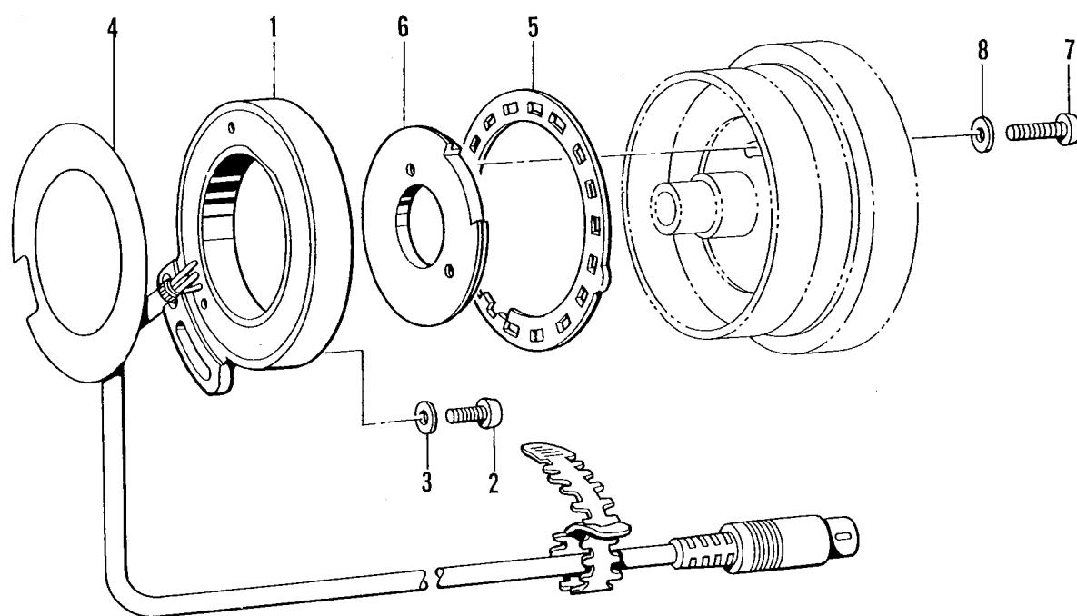
T. ゲージ部品関係 / Gauge mechanism / Lehenvorrichtung /
