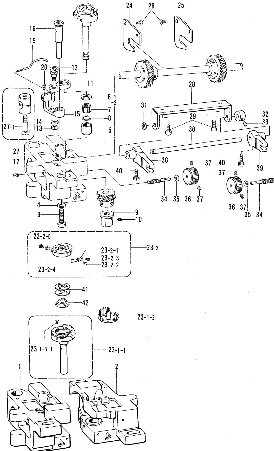
F. カマ関係 / Rotary hook mechanism / Greifervorrichtung /
