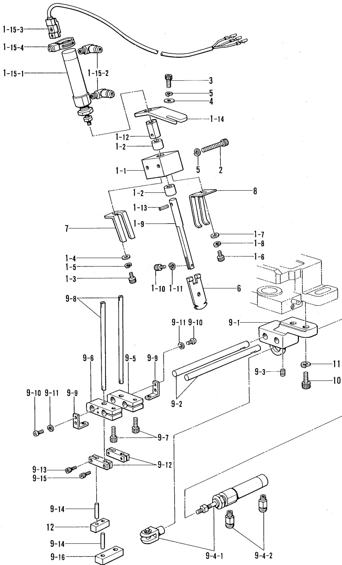
M. 糸切り関係 / Thread trimmer mechanism / Fadenabschneidevorrichtung /
