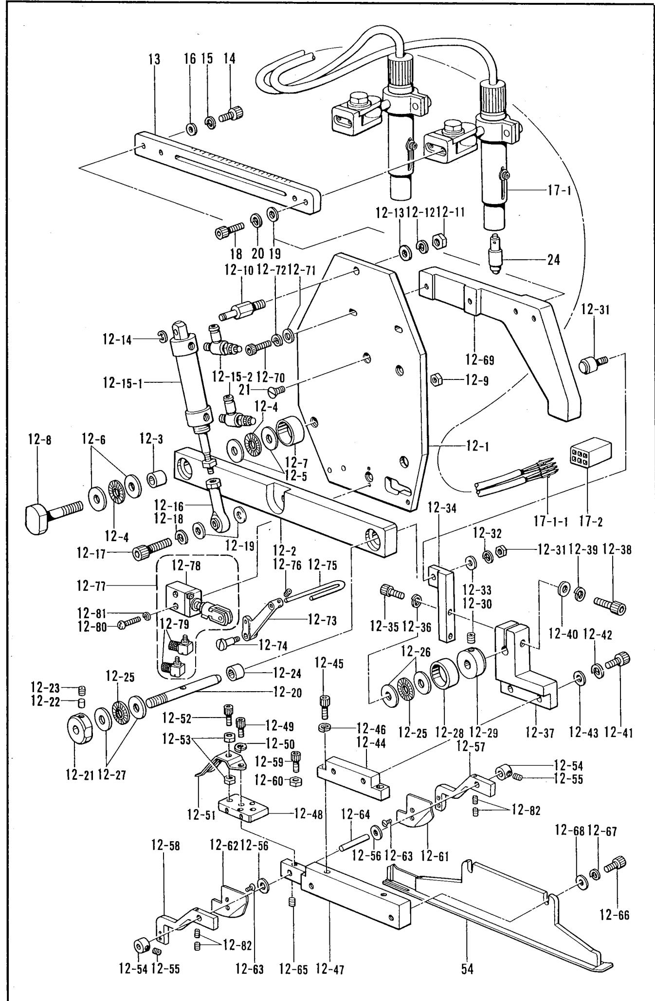
R. 布制御関係 / Cloth control system mechanism / Stoffführungs vorrichtung /
